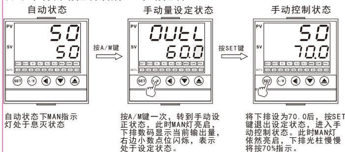
\*\*手动控制状态下按A/M键可转为自动控制。
